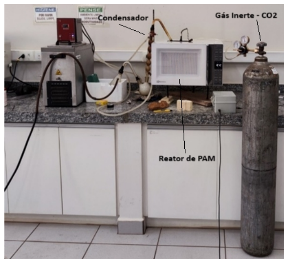
Figura 1. Sistema para realização de PAM em operação.
